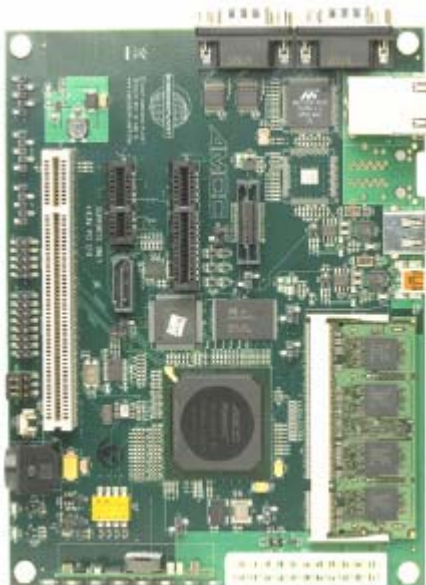
图 2. PowerPC 460EX 评估套件外形图
