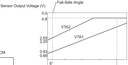
Throttle Valve Opening Angle (°)
