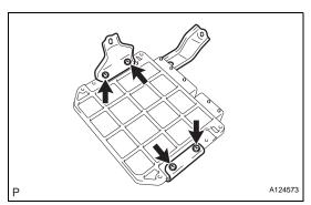
(d) Remove the 4 screws and 2 ECM brackets.
