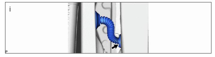
(1) Disengage the grommet.
