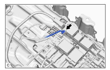
(d) Disconnect the hybrid vehicle control ECU connector.
