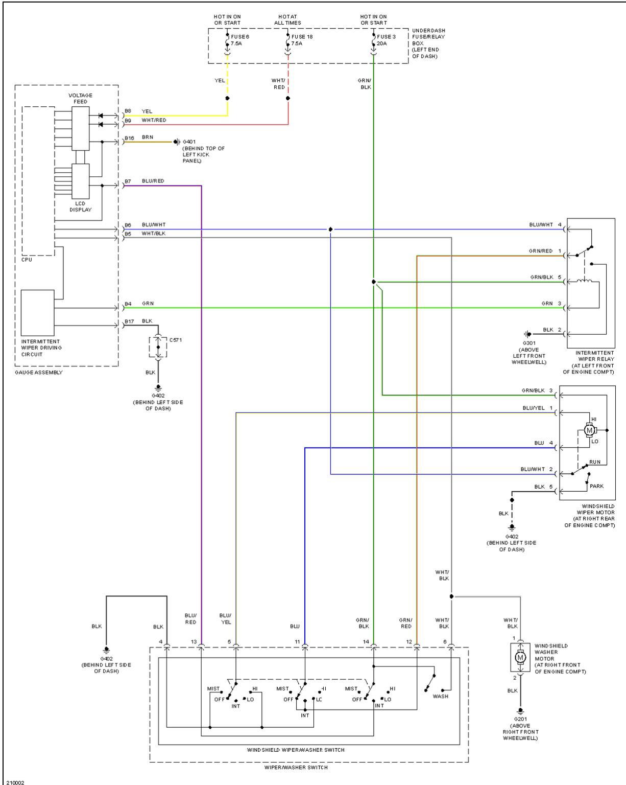
**Fig. 46: Front Wiper/Washer Circuit**
