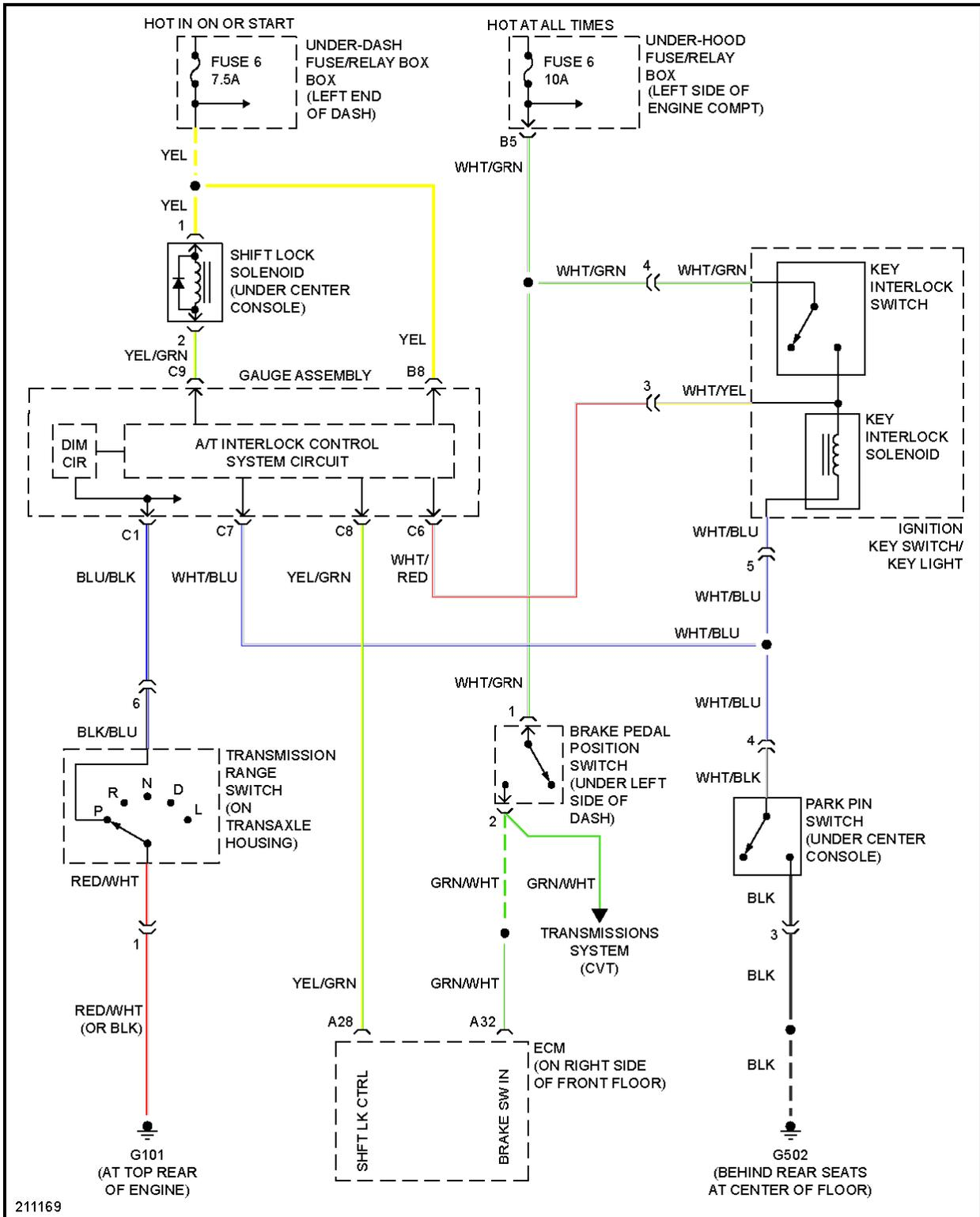
**Fig. 40: Shift Interlock Circuit**
