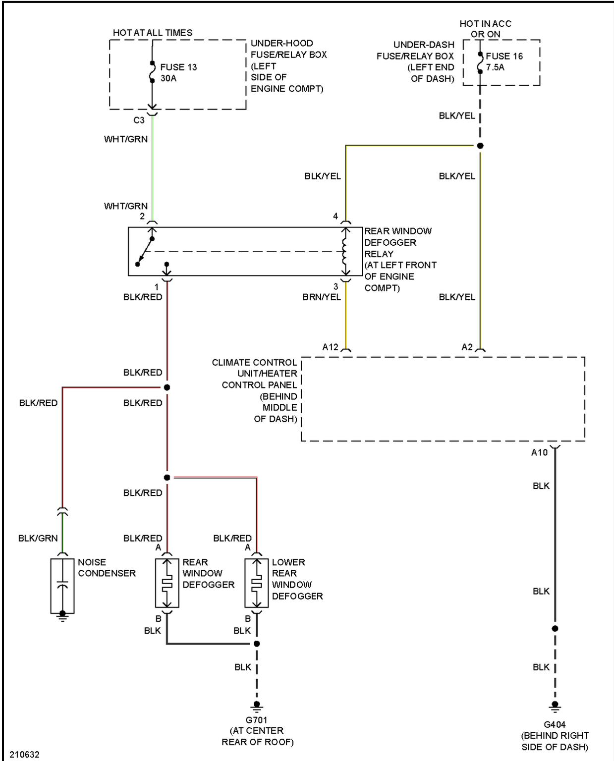
**Fig. 9: Defoggers Circuit**
