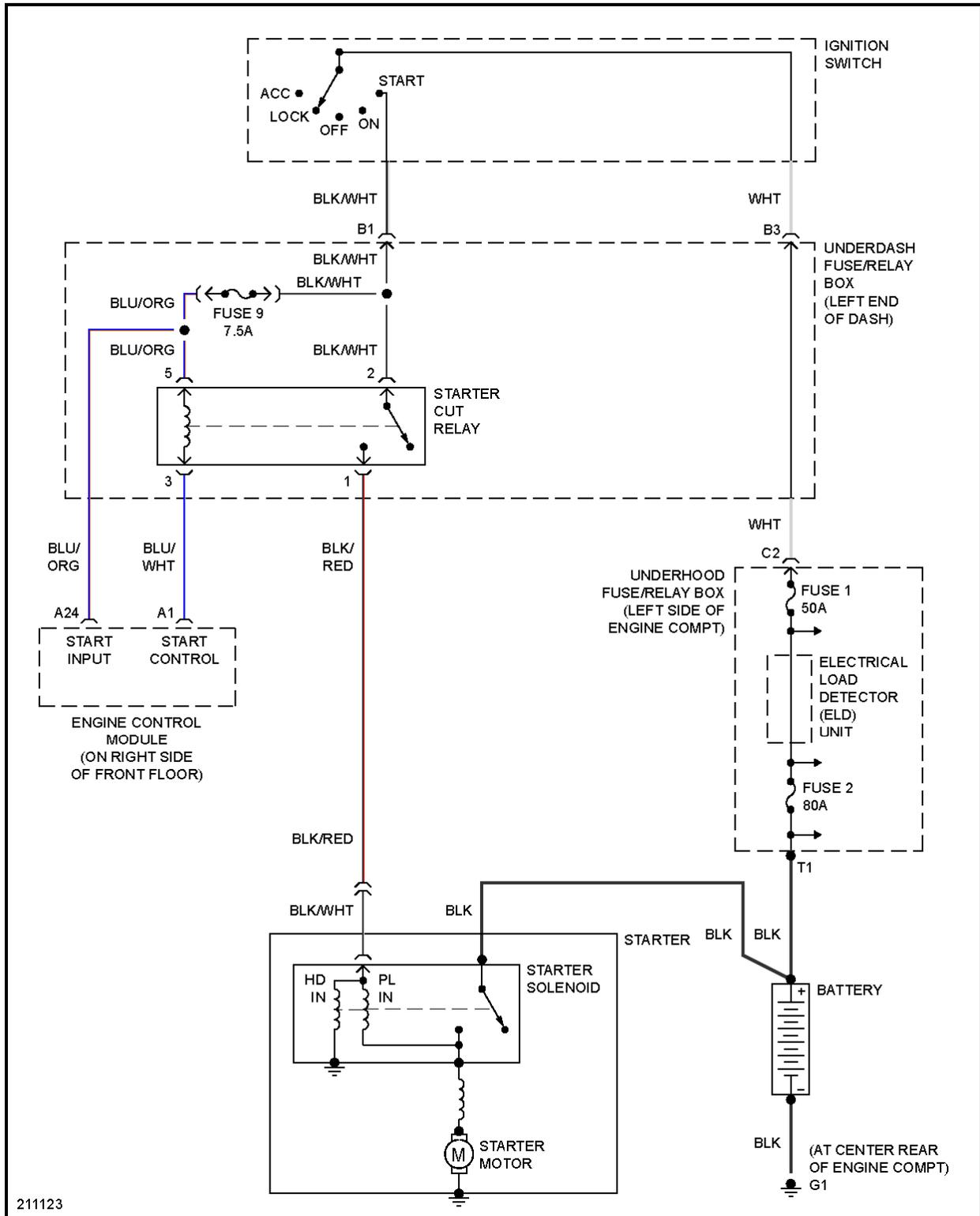
**Fig. 41: Starting Circuit**
