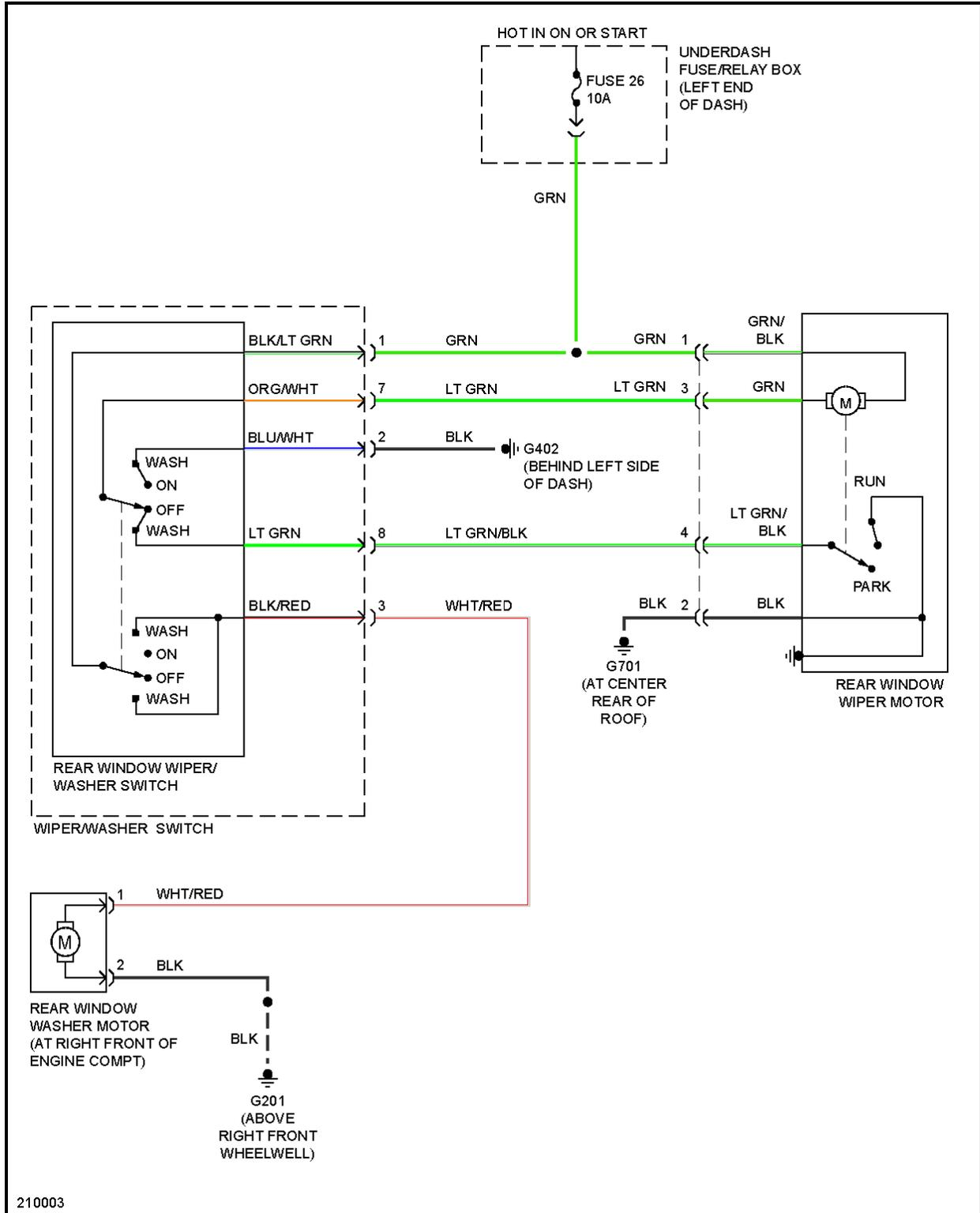
**Fig. 47: Rear Wiper/Washer Circuit**
