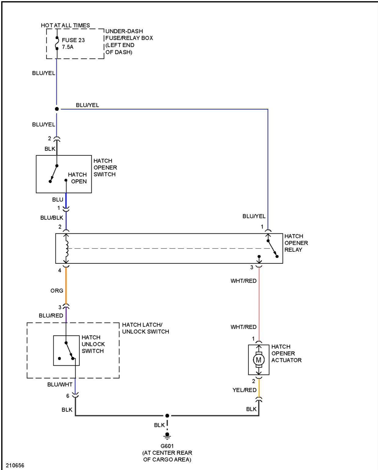
**Fig. 44: Hatch Release Circuit**
