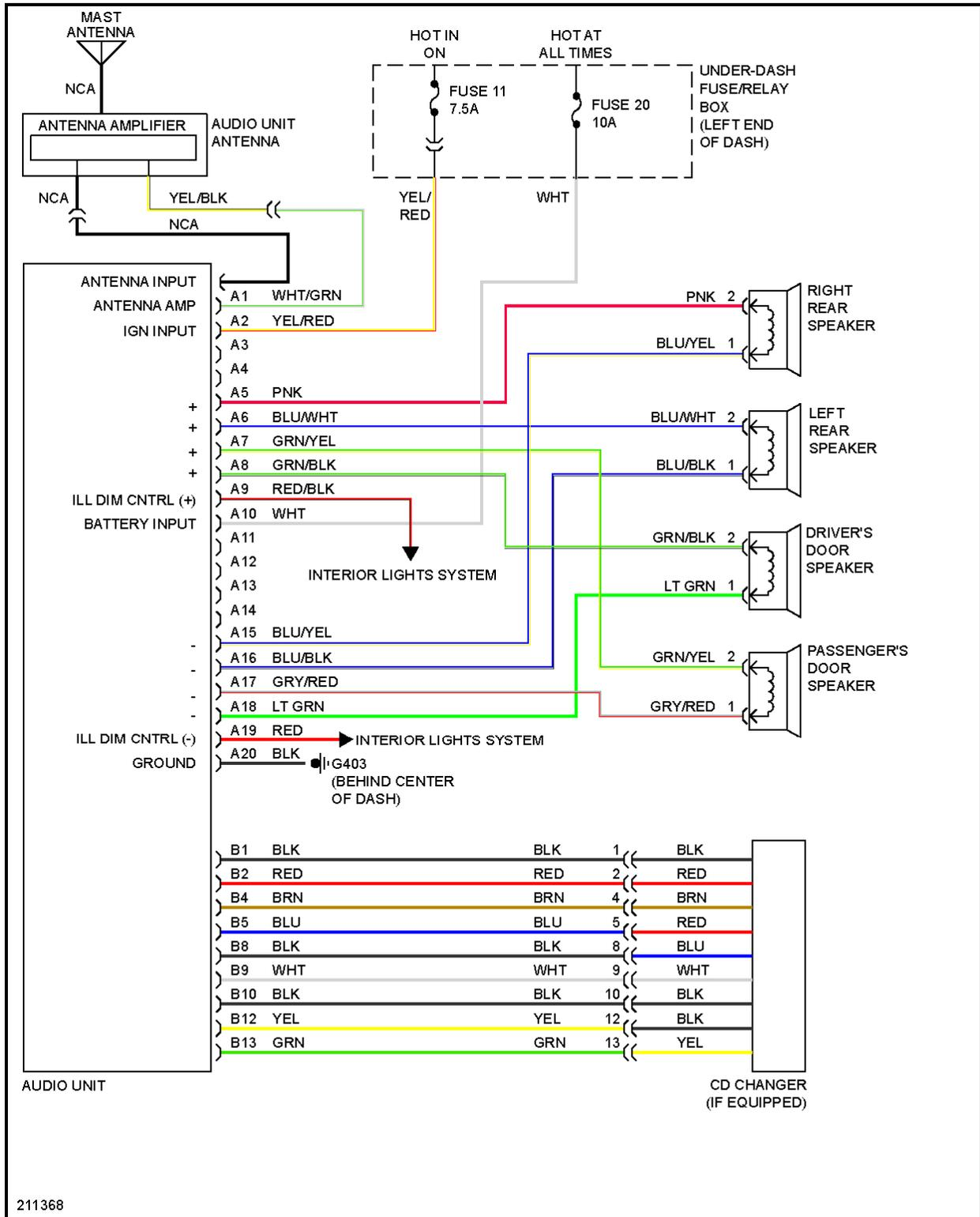
**Fig. 39: Radio Circuit**
