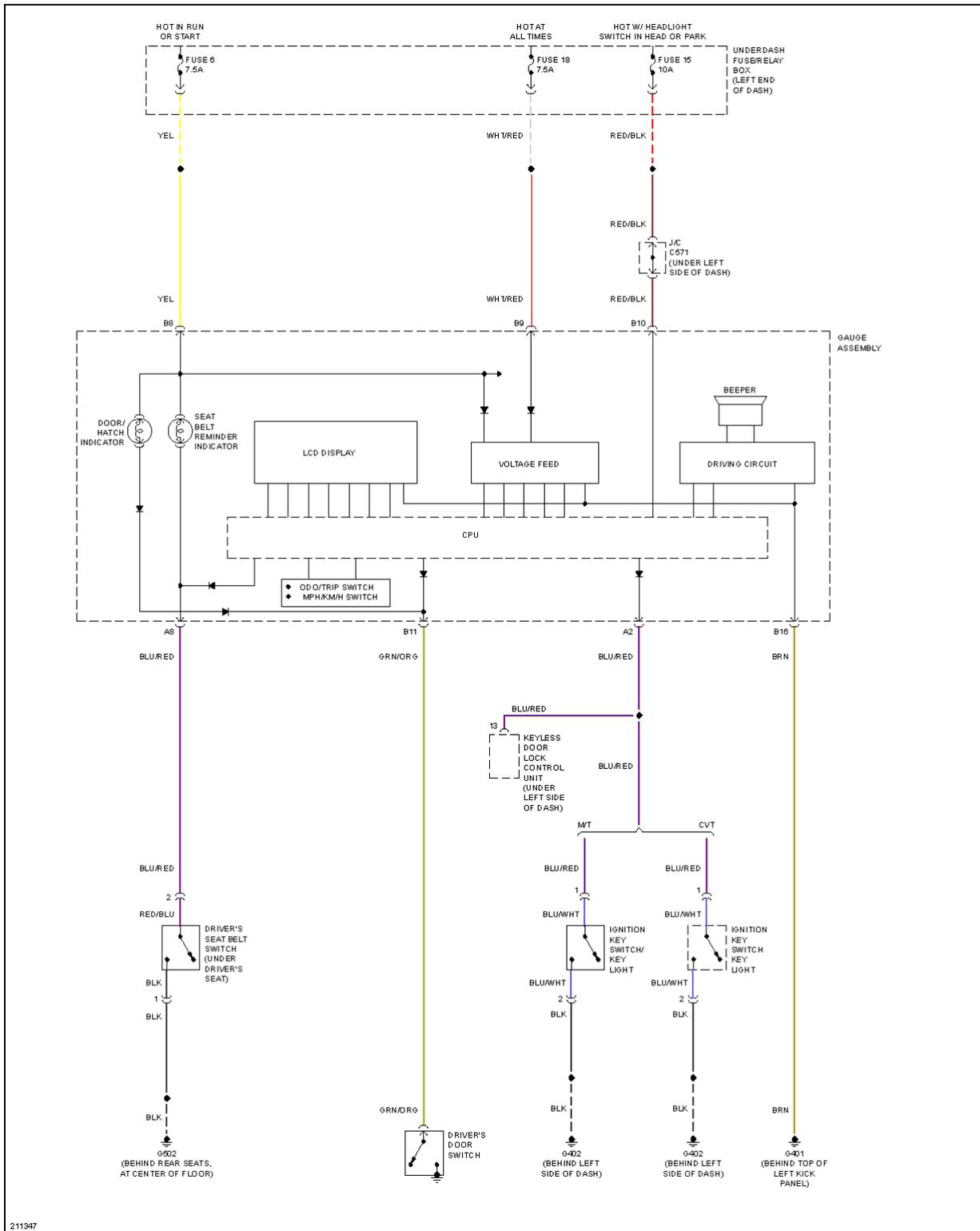
**Fig. 45: Warning Systems Circuit**
