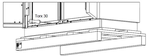
Lösen Sie die Befestigungsschrauben des vorderen Sockels.
